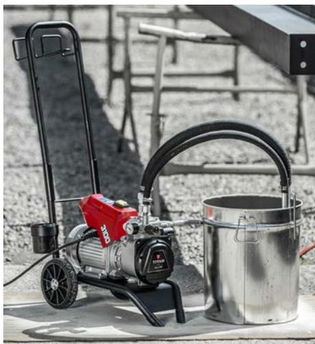
Es una bomba eléctrica mini hidráulica, que cumple con las más altas expectativas de durabilidad. El diseño robusto de la bomba es versátil y se puede cambiar fácilmente entre el sistema de aspiración o la tolva.
