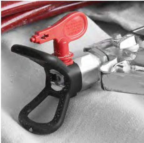
Las boquillas de pulverización airless son un elemento clave para que el sistema de pulverización airless opere con éxito. Sirven para definir el patrón de pulverización, controlar el flujo, atomizar el revestimiento y, por último, indicar a la bomba con qué potencia debe actuar. La comprensión correcta de las boquillas airless es fundamental para que todas las aplicaciones airless se realicen con éxito.
