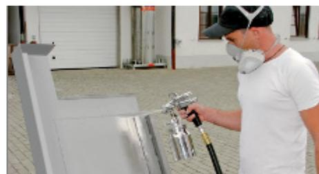
El chorro de pulverización se puede ajustar directamente en la pistola con precisión al objeto en particular en una sola operación.
