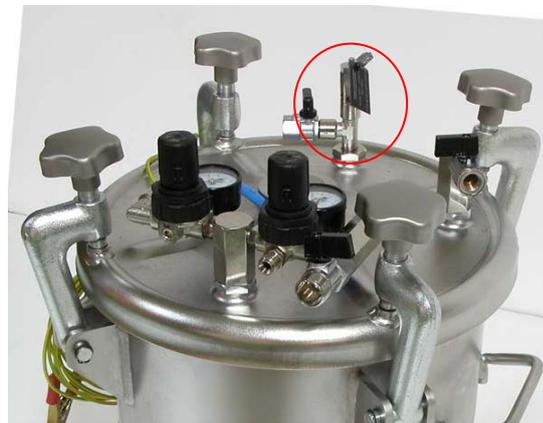
📷 Posición de válvula de seguridad en tapa
