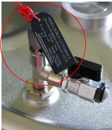
📷 Detalle de válvula de seguridad
