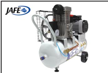
o **Compresor serie DECO pro** especialmente indicado para trabajar con equipos de gotelé. 220v monofásico de 2 hp, con cabezal de aluminio, dos cilindros, cigüeñal de doble apoyo y visor de aceite.
