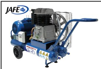
o **Compresores DECO turbo** especialmente indicado para trabajar con equipos de gotelé. 380v trifásicos de 5,5 y 7,5 hp respectivamente, con cabezal de aluminio, dos cilindros, cigüeñal de doble apoyo y visor de aceite.
