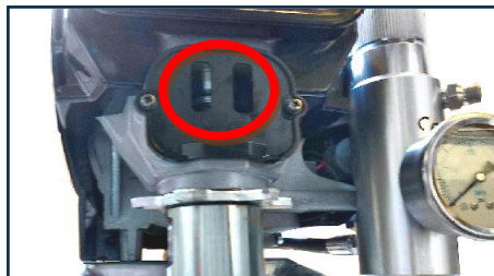
Ranuras para lubricación de las empaquetaduras del pistón de la bomba
