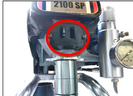
Ranuras para lubricación de las empaquetaduras del pistón de la bomba
