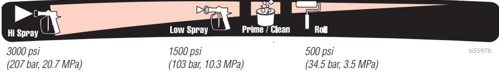
Para seleccionar una función, alinee el símbolo de la perilla de control de presión con el indicador de ajuste del pulverizador.
