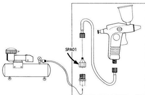
Si utiliza un compresor, utilice un adaptador de 1/4" y conecte la manguera de aire. Controle la presión de trabajo con un regulador.
