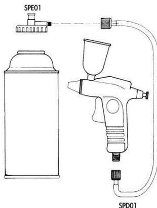
\*Si usa propelente, conecte la manguera de aire al regulador del bote.
