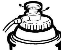
La válvula reguladora de aire está diseñada para botes de propelente, lo que ajustará la presión de 1 a 3,5 Bar. Para trabajos prolongados se recomienda utilizar un compresor.
