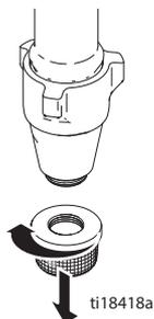
3. Retire el racor de la manguera de pintura y la manguera de pintura del racor de la bomba.
