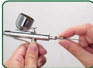
5- Para colocar de nuevo la aguja, presione el gatillo e introdúzcala con cuidado para no dañar el difusor. Utilice alcohol industrial o disolvente cuando resulte difícil eliminar la suciedad (tinta, colores acrílicos, etc.)
