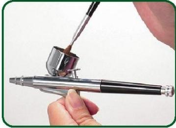
1- Pintura que quede en el depósito, eche un poco de agua y límpielo con un cepillo. De nuevo eche agua y apriete el gatillo para pulverizar el agua.
